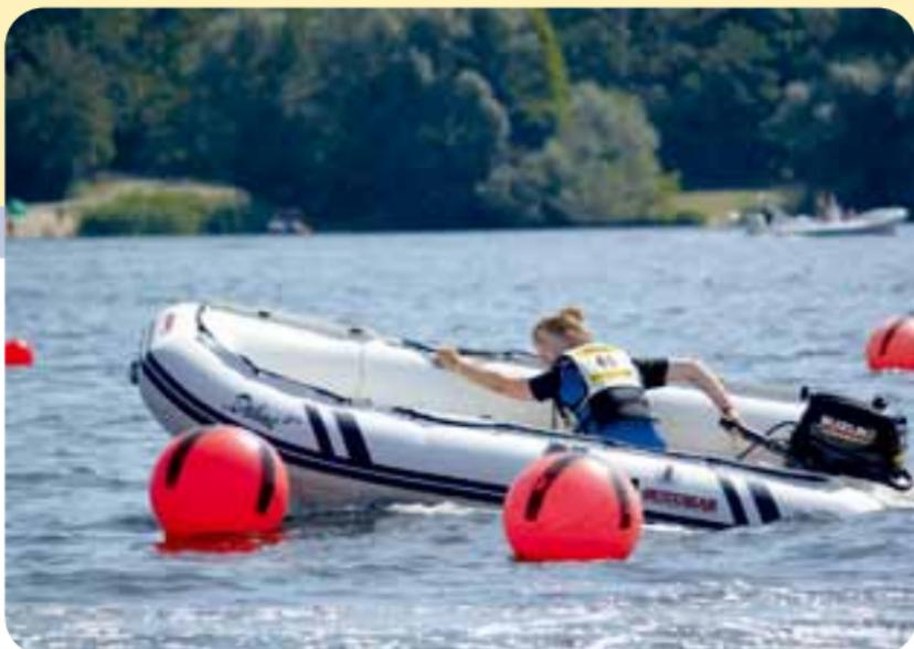
Schlauchboote mit einem „Quickstop“ ausgestattet. Das ist eine Gummileine, die am Bein des Fahrers und am „Not-Aus“ des Außen-bordmotors befestigt wird. Sollte nun der Fahrer aus dem Boot fallen wird die Zündung des Motors unterbrochen und der Motor geht sofort aus.
